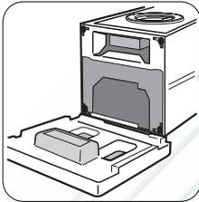
Снимите полистироловое основное и пластиковую опорную раму, на которых лежит машина.
