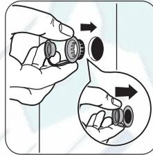
В освободившиеся три отверстия необходимо вставить входящие в комплект поставки пластмассовые заглушки, находящиеся вместе с руководством по эксплуатации в полиэтиленовом пакете внутри барабана.
