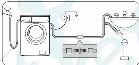
Информация по электрическому подключению представлена на табличке технических данных, расположенной на внутренней стороне дверцы машины.
