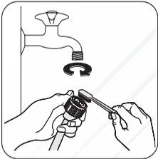
Закройте водопроводный кран. Отвинтите наливной шланг. Прочистите фильтр жесткой щеткой. Привинтите на место наливной шланг.
