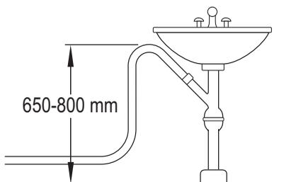
Сливной шланг можно ввести непосредственно в трубу (например, под раковиной или кухонной мойкой) над водозатвором. Сливной шланг надо прокладывать так, чтобы часть его была поднята вверх до уровня верхнего края раковины и там зафиксирована.
