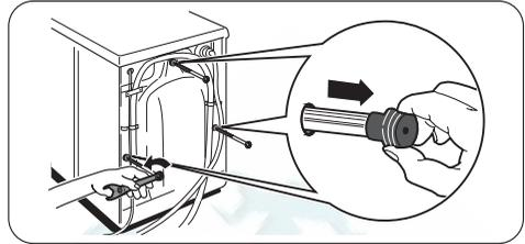
С помощью подходящего гаечного ключа на задней панели машины вывинтите три болта и снимите их вместе с прокладками.
