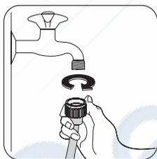
Присоедините наливной шланг к водопроводному крану с резьбой 3/4". Всегда используйте шланг, поставляемый вместе с прибором.
