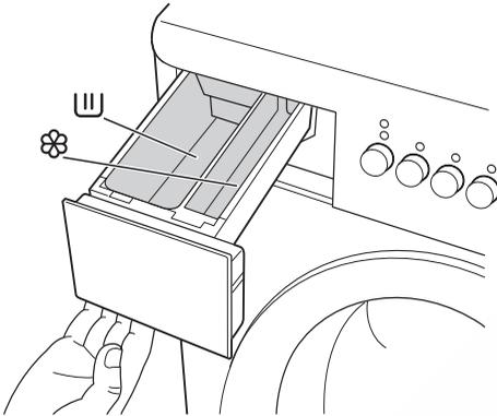
U Отделение для порошкового или жидкого моющего средства, используемого при основной стирке. При использовании жидкого моющего средства наливайте его **непосредственно перед** запуском программы.
